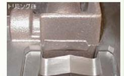
FC、FCD など幅広い材質の製品に対応した金型です。機械加工による型の修正・調整、初期金型データを保存することにより複製が可能。他社製の場合でも、製品を三次元測定し金型を製作します。金型は抜き落とし式・定置式・一体型・分割型など、あらゆる対応が可能です。また、刃物は重切削や加工ミスの際にも素早く取り換えができます。サンプルを送付いただければ、ご相談やお見積りに応じさせていただきます。
