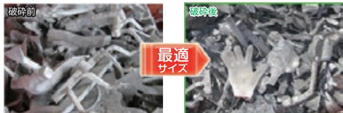
※ランナーブレイカー ALP1500K アルミ合金専用破碎機 使用。破碎機の仕様や被破碎物により、破碎結果は異なります。
